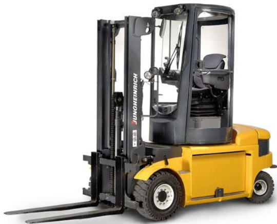
Heftruck met draaibare chauffeurscabine
